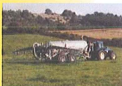
Tonne à lisier avec rampe à pendillards
